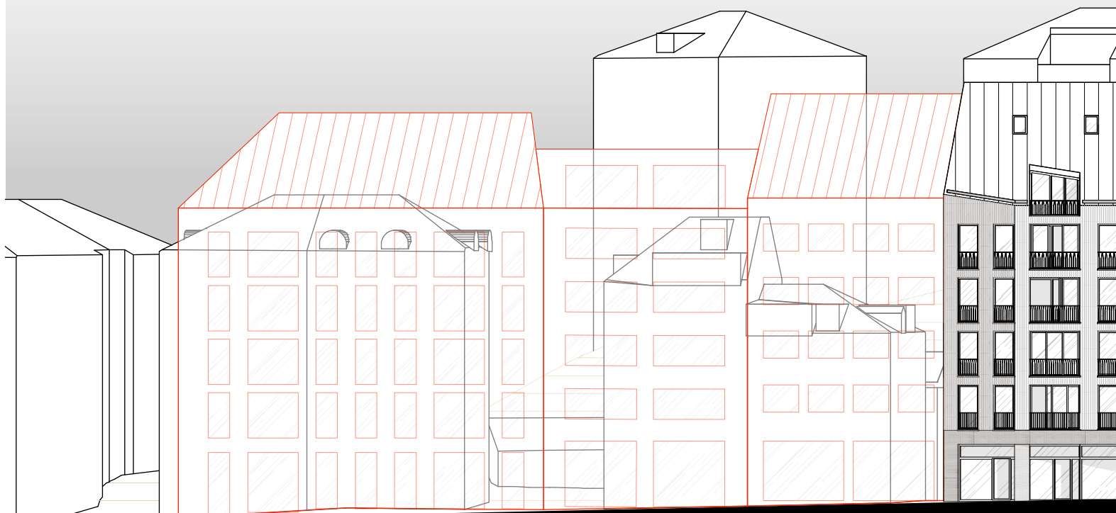
Ansicht und Kataster des Neubauprojekt an der Maihofstrasse 8. Rot eingezeichnet die möglichen Volumina der Nachbarparzellen, mit Sattel- oder Flachdach.
